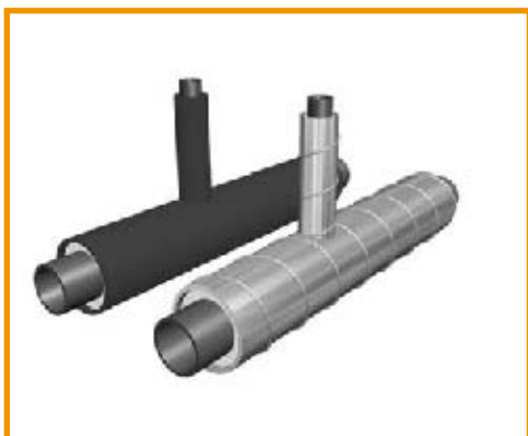
1. Пример условного обозначения Тройника стального (стального оцинкованного) с наружным диаметром основной трубы 219 мм и толщиной стенки 6 мм, диаметром трубы ответвления 89 мм и толщиной стенки 4 мм, с изоляцией типа 1 из пенополиуретана в полиэтиленовой (оцинкованной) трубе-оболочке. Тройник Ст (Ц) 219х6-89х4-1-ППУ-ПЭ (ОЦ)
