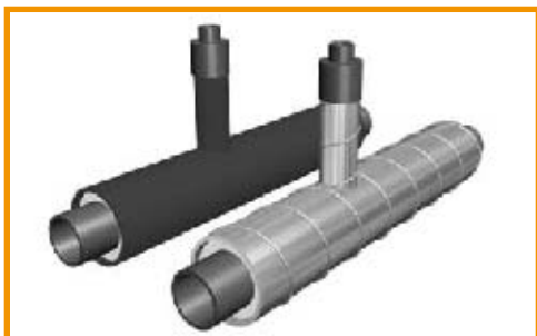
2. Пример условного обозначения Тройника стального (стального оцинкованного) с наружным диаметром основной трубы 219 мм и толщиной стенки 6 мм, диаметром трубы ответвления 89 мм и толщиной стенки 4 мм, с изоляцией типа 1 из пенополиуретана в полиэтиленовой (оцинкованной) трубе-оболочке с металлической заглушкой изоляции длиной 200 мм с закольцовкой проводников СОДК. Тройник Ст (Ц) 219х6-89х4-1-ППУ-ПЭ (ОЦ)- 200 ЗМ
